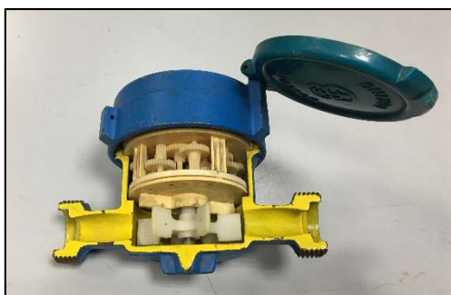
Fig.6 – Contatore dell'acqua a turbina per usi domestici in sezione
