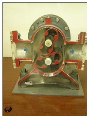
Fig.7 – Contatore dell'acqua volumetrico a lobi in sezione
